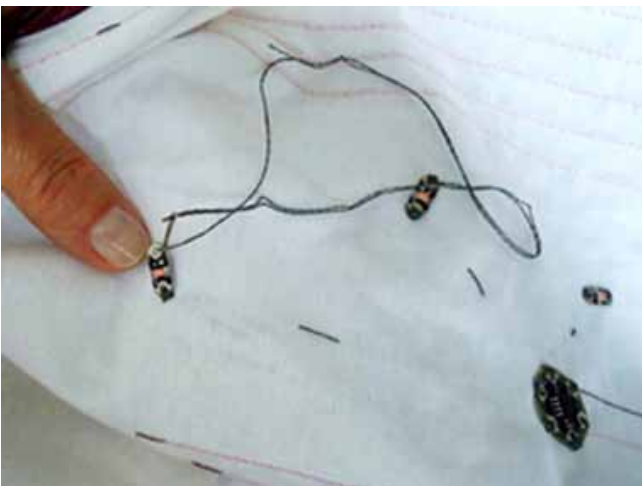
Figura 9 – Coser a partir da frente, no sítio indicado para colocar o e-material.
